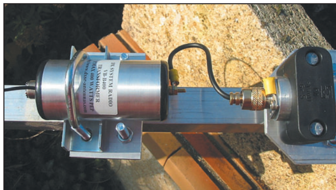
4 - Le montage du transformateur d'impédance.
