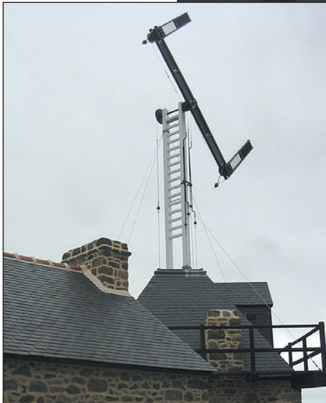
6 - Les bras du télégraphe recopiant la position du manipulateur.
