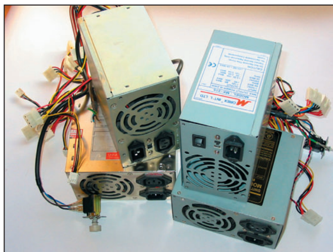
Photo 1: Alimentations standards de PC. Souvent ce sont des 200 W mais, sous le même format, certaines font 250 voire 300 W.
