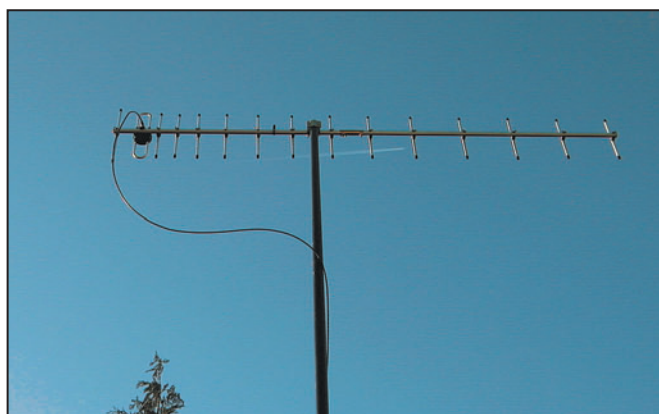
1 - La 435WH15 montée ici en polarisation verticale.
