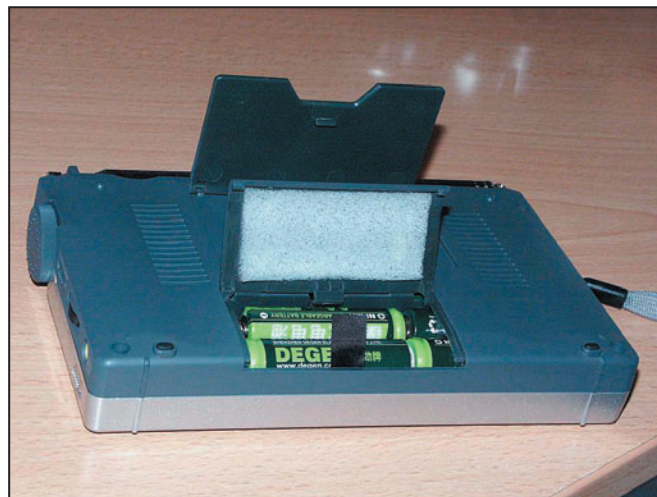
3 - Vue arrière, béquille, trappe à batteries et accus Ni-MH livrés.
