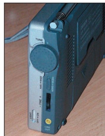
5 - Côté droit : encodeur, sélectivité, BFO, sortie ligne.
