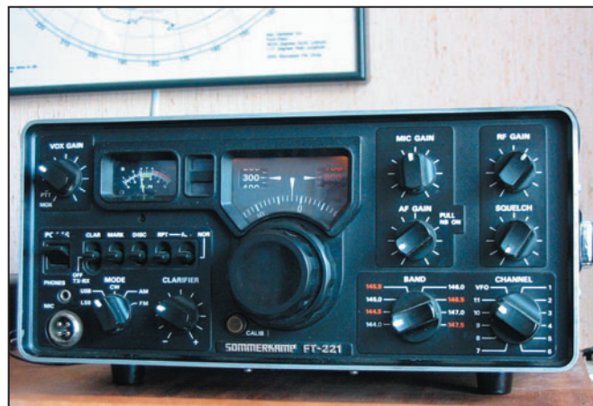
Un transceiver VHF multimodes déjà ancien mais toujours vaillant, le FT-221.
