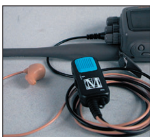
1 - Remarquez le boîtier permettant le passage en émission.
