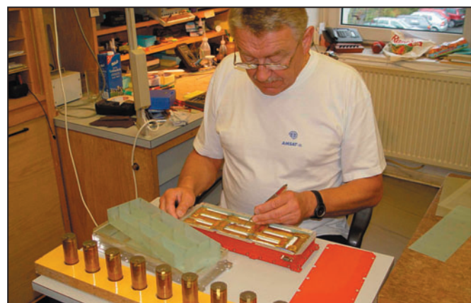
13 - Assemblage d'un module batterie.
