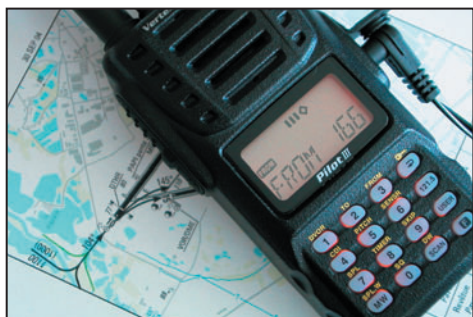
2 - Ici, en mode VOR, avec affichage de la radiale en gros caractères et de l'écart de route.
