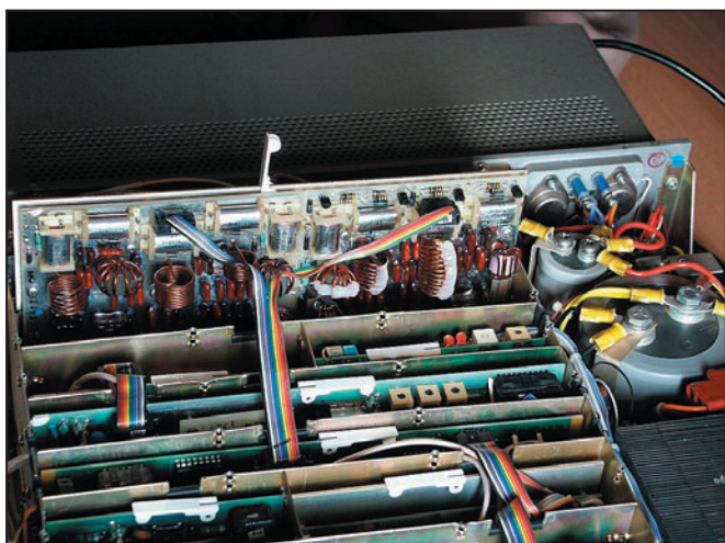
8 - Vue des cages blindées. La carte sortie : couverture générale émission (A3).
