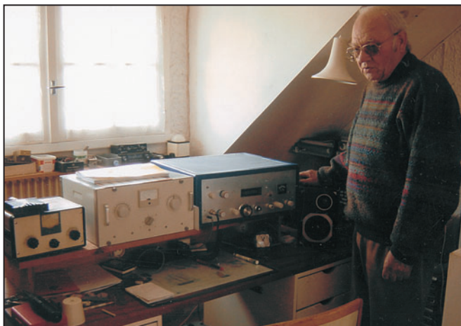
1 - Sur cette table, on ne voit que la station déca : transceiver dont le fréquencemètre est celui de F1BBU, le linéaire (une seule 8122 en service "au petit trot" délivrant 50 à 60 W et la boîte de couplage).
