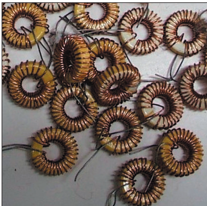
3 - Répartition homogène des spires sur le tore.
