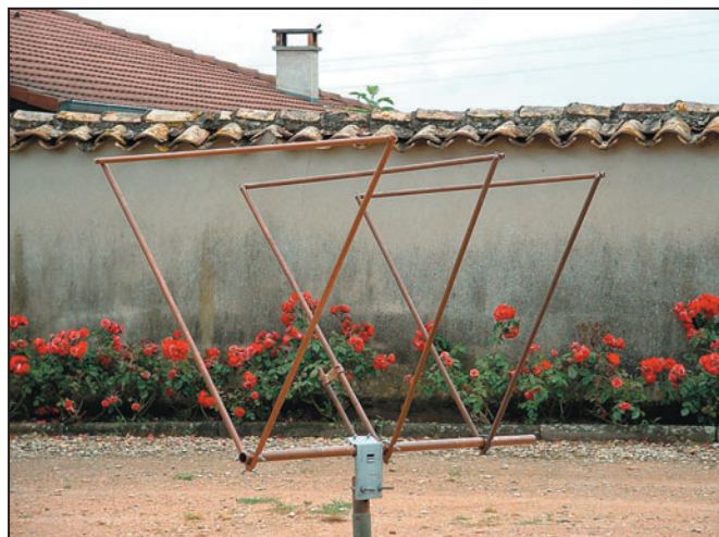
2 - L'antenne 3 éléments, "prototype" en cuivre.
