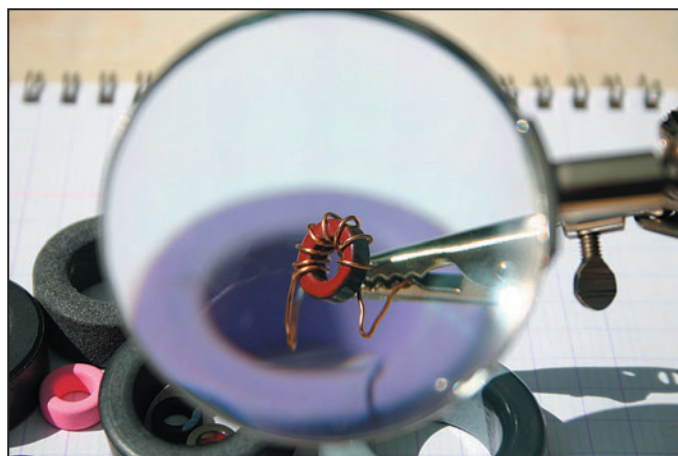
2 - Bobinage d'un tore, chaque passage au centre compte pour un tour.
