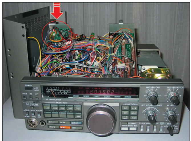
9 - Le TS-440 en cours de modification. On peut voir le module DSP installé en haut à gauche de la carte "IF Unit" qui a été soulevée.
