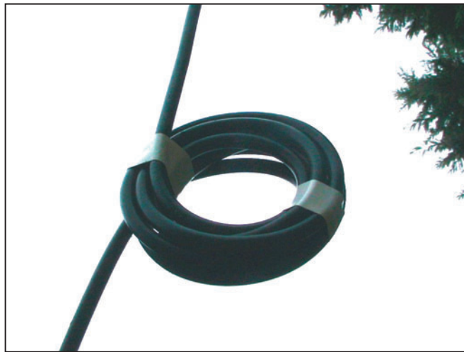
4 - Self d'arrêt pour courants de gaine en câble coaxial.
