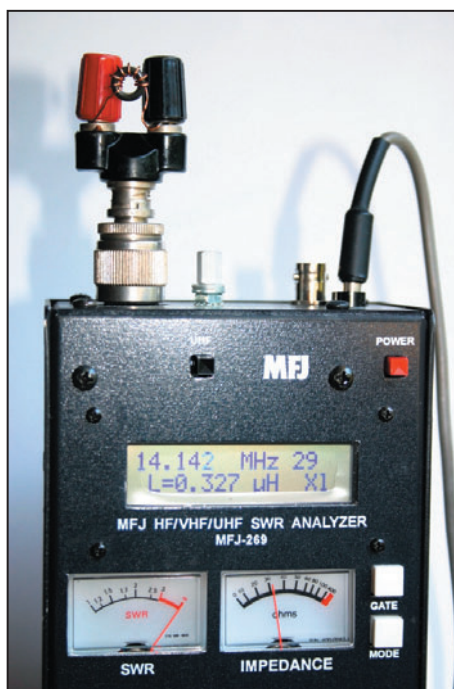
6 - Mesure d'un tore inconnu à l'aide d'un MFJ-269.
