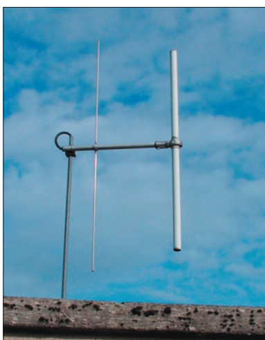
5 – Antenne composée d'un réflecteur et d'un radiateur.
