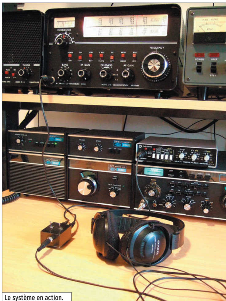
Le boîtier d'aiguillage BF.
