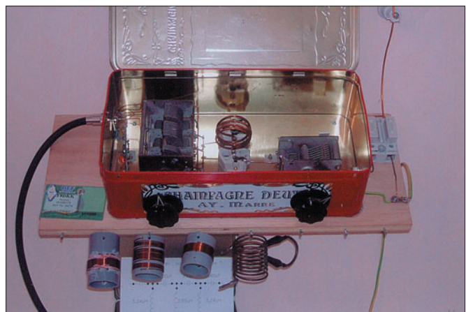
3B - Photo du filtre en Pi (Collins) et de ses selfs.
