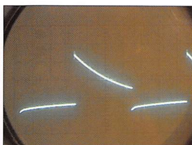
6 - Signal mesuré sur l'entrée d'une porte du 7400.
