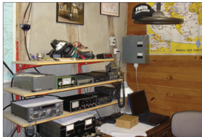
2 - Une autre vue de la station. La casquette est posée sur le volant permettant de tourner directement les antennes !
