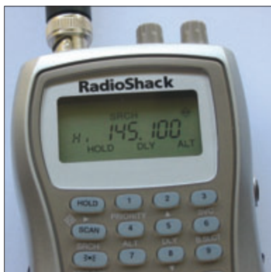
6 - Il suffit alors d'appuyer sur une touche pour faire apparaître la fonction fréquencemètre et la valeur de la fréquence mesurée.
