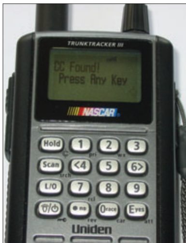
7 - Le fonctionnement du système "Close Call" sur le scanner UNIDEN BR330T. Sur la première ligne de l'afficheur, on voit l'indication du S-mètre par 5 barres (ce n'est pas très lisible !). L'indication de fonctionnement du "Close Call" est marquée en bas à droite de l'afficheur par un rond dans une cible. Dès qu'une fréquence est capturée, l'afficheur indique "CC Found".
