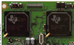
Le double DSP 32 bits embarqué.
