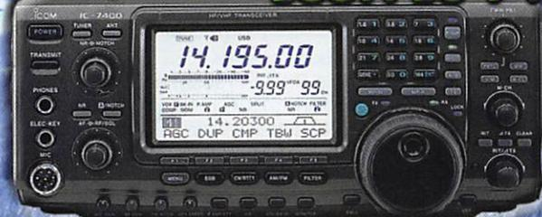
Emetteur-récepteur HF, 50 et 144 MHz, tous modes. DSP FI 32 bits, keyer et coupleur automatiques intégrés, démodulateur RTTY, large écran LCD, 102 mémoires, puissance de 100 W, etc...
