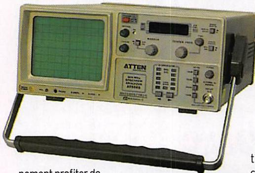
nement profiter de ces productions de masse à bas coût. Un brillant exemple nous est proposé avec cet analyseur de spectre, l'Atten AT-5005, proposé à 550 euros HT en Italie, couvrant de 150 kHz à 500 MHz, avec une sensibilité de -90 dBm. Dans les accessoires prévus pour cet appareil, un convertisseur permet d'étendre la gamme couverte jusqu'à 2 GHz [www.maruccci.it].
