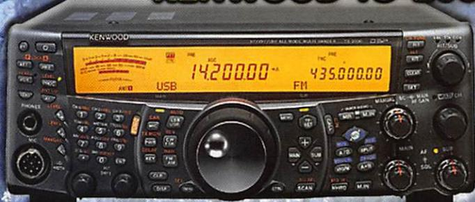
Emetteur-récepteur HF, 50, 144 et 430 MHz (1200 MHz en option), tous modes. Boîte d'accord automatique, DSP sur les FI, double récepteur, "keyer" électronique, TNC 1200/9600 bauds (packet-radio/APRS/DX-clusters), fonction "satellites", TCXO et interface pour pilotage par ordinateur intégrés ! Le meilleur rapport qualité/prix du marché dans sa catégorie.
