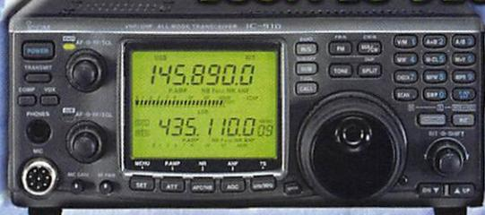
Emetteur-récepteur 144 et 430 MHz (1200 MHz en option, 10 watts), tous modes, full-duplex, keyer électronique, mode "satellites", large écran LCD, FM étroite et large. Le meilleur rapport qualité/prix du marché dans sa catégorie.
