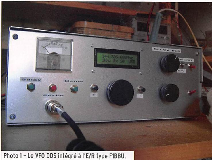
Photo 1 - Le VFO DDS intégré à l'E/R type F1BBU.
