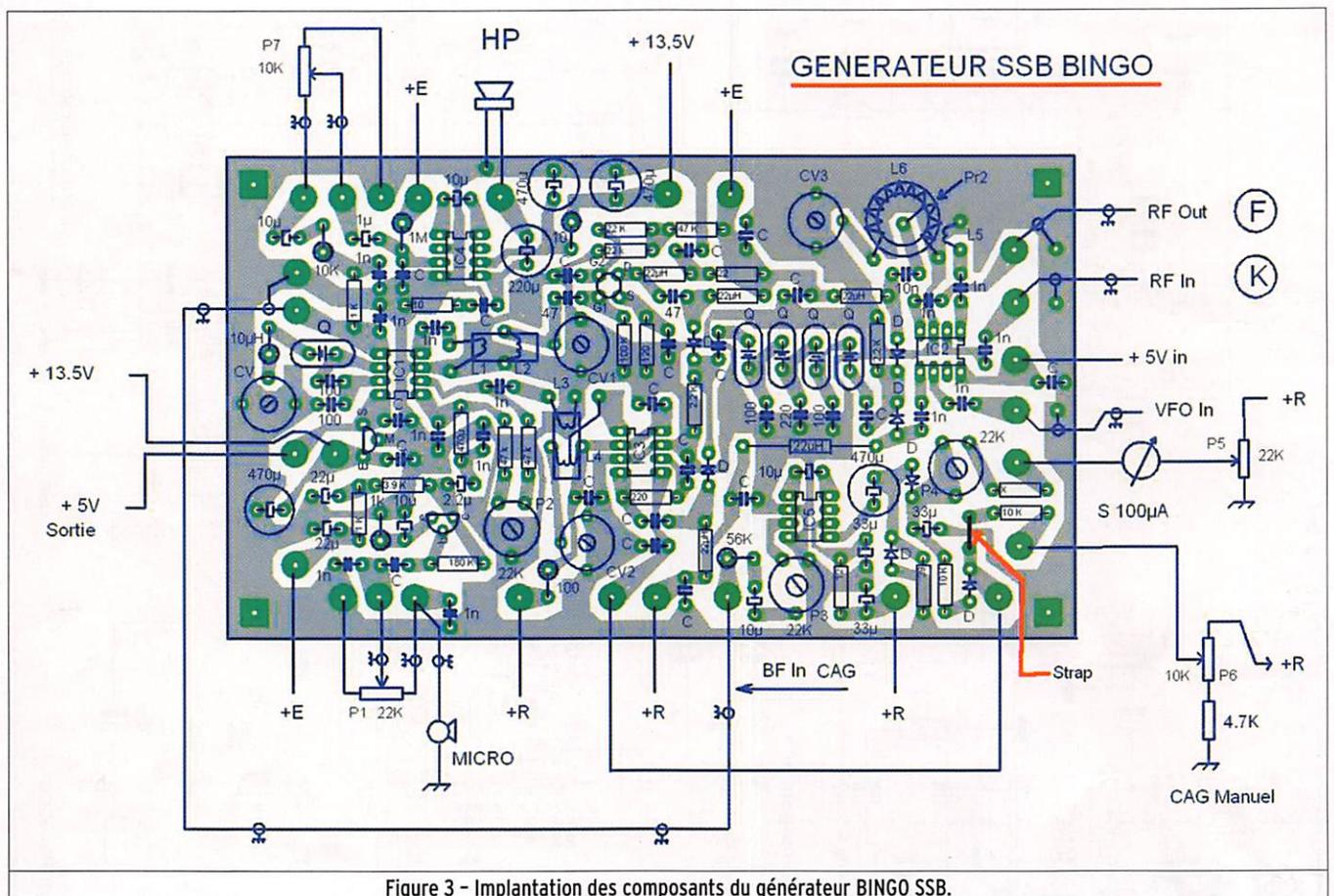
Figure 3 - Implantation des composants du générateur BINGO SSB.
