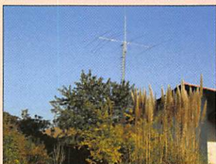
1 - La SteppIR : une antenne assez impressionnante une fois montée, (remarquez les éléments "parasites" 50 MHz).
