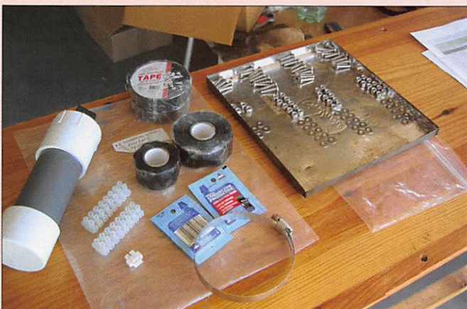
9 - L'inventaire d'une pochette avec le tube de protection pour le câblage des dominos.
