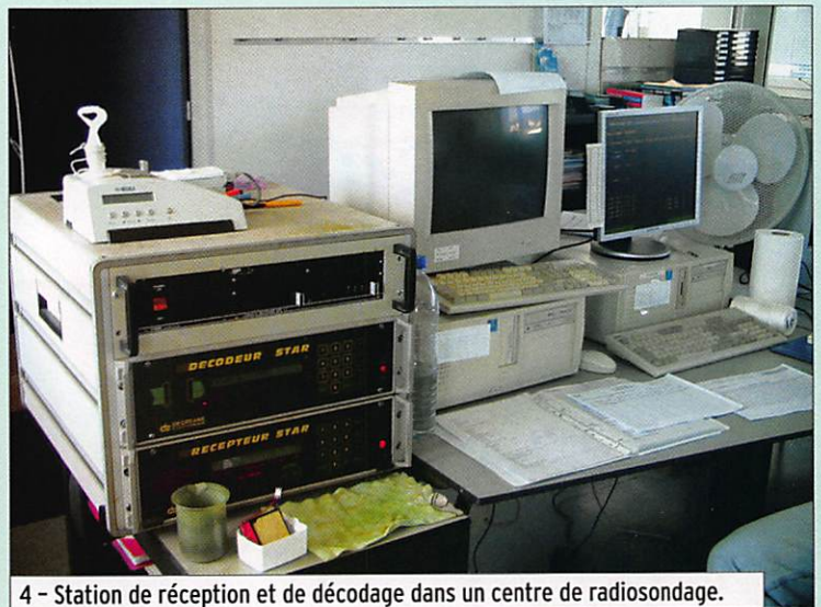
4 - Station de réception et de décodage dans un centre de radiosondage.
