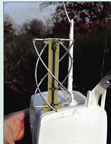
4 - Une RS92-SGP avec son antenne GPS.
