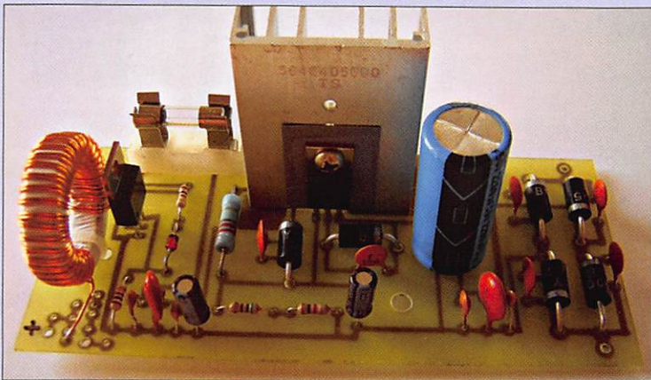
Le circuit imprimé de l'alimentation équipé de tous ses composants.
