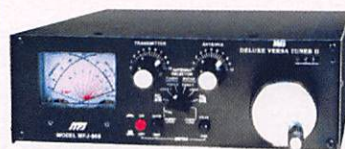
MFJ 969 Coupleur HF/50 MHz. Self à roulette. Commutateur antenne. Balun interne 4:1. Charge incorporée. Wattmètre à aiguilles croisées.
