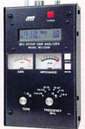
MFJ 259B Analyseur d'antennes de 1,8 à 170 MHz. Fréquencemètre 10 digits + affichage ROS et résistance HF par galvanomètres. Mesure des impédances complexes. Utilisation en fréquencemètre. MFJ-66 — Adaptateur dipmètre pour MFJ-259.
