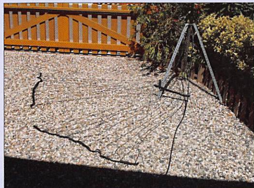
1 - Deux nappes installées au pied du trépied de l'ATAS-120.
