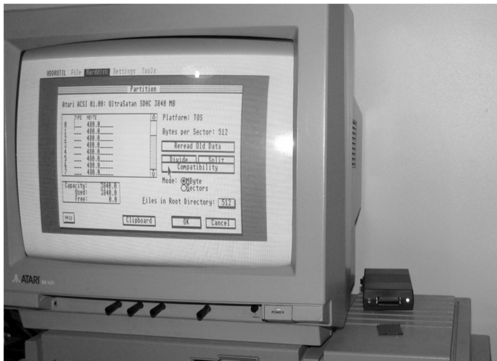
Partitionnement d'une carte SD de 4 Go sur un Mega STE
